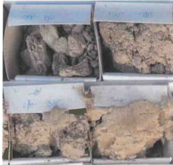
איור 2: דגימות מפרופיל הקרקע שהתקבלו מקידוח ניסיון BH-2
