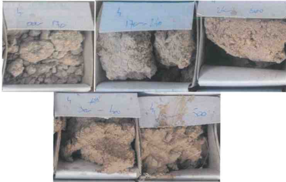
איור 4: דגימות מפרופיל הקרקע שהתקבלו מקידוח ניסיון BH-4
