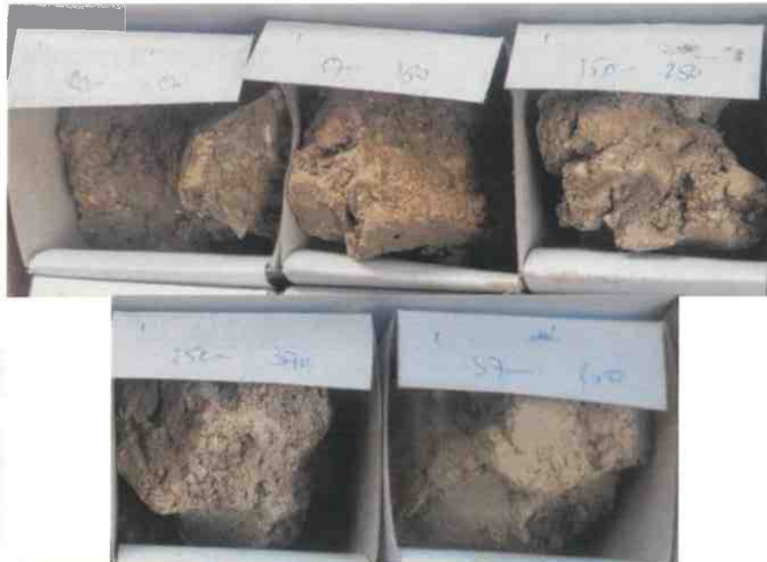
איור 1: דגימות מפרופיל הקרקע שהתקבלו מקידוח ניסיון BH-1
